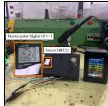
Gambar 22. Hasil Pengujian Sensor DHT22 yang dibandingkan dengan Thermometer Digital HTC-1
