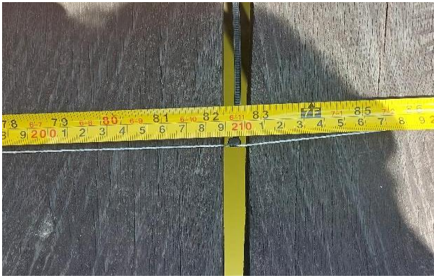
Gambar 25. Pengukuran ketinggian sensor dengan permukaan air
