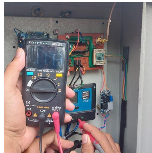
Gambar 28. Pengukuran nilai arus yang mengalir ke beban dari SCC
