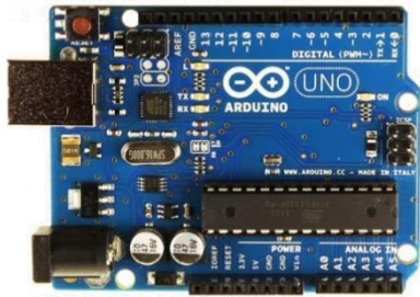
Gambar 3. Tampilan Arduino Uno [9]
