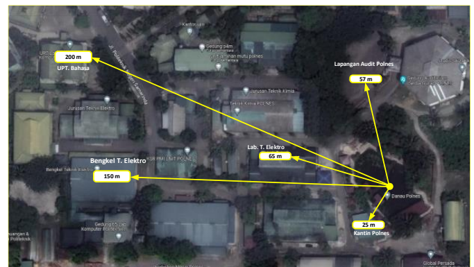
Gambar 20. Jarak antara lokasi pengukuran receiver dengan transmitter
