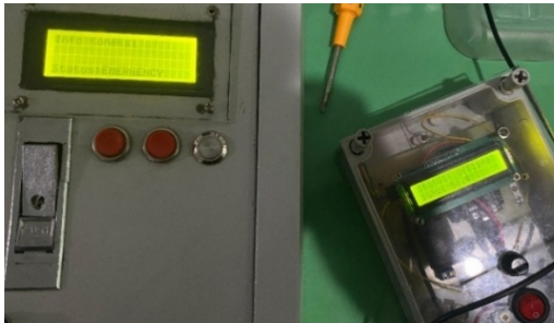
Gambar 25. Esp32 Box mengirim data ketika terjadi overheat .
