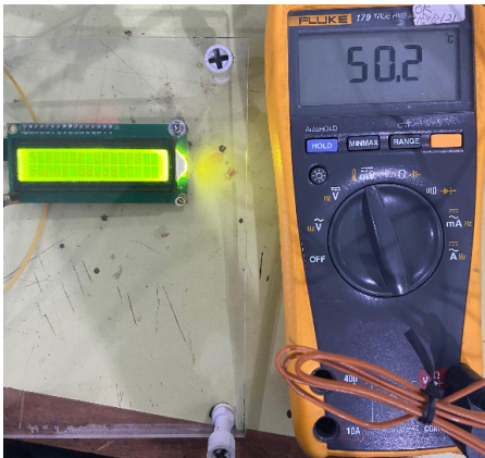
Gambar 22. Perbandingan suhu antara sensor ds18b20 dengan thermocouple type-k
