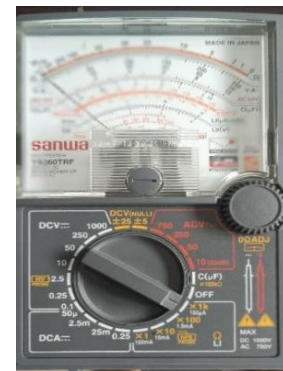
Gambar 4. Jangkah pengukuran pada posisi pengukuran resistor
