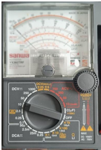
Gambar 6. Jangkah pengukuran pada posisi pengukuran tegangan DC
