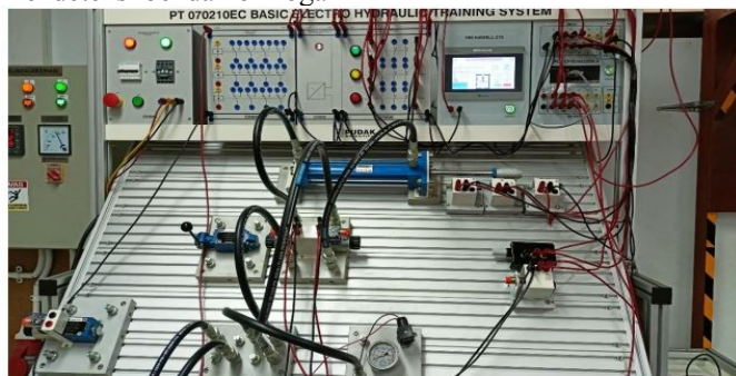
Gambar 31. Pengujian Sistem Mode Partial Press
