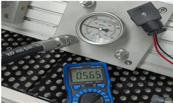
Gambar 29. Pengujian Input Analog dengan Multimeter
