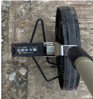
Gambar 2. Pengukuran awal panjang Jalan Tani Subur dari measure wheel menunjukkan nilai 0000 meter
