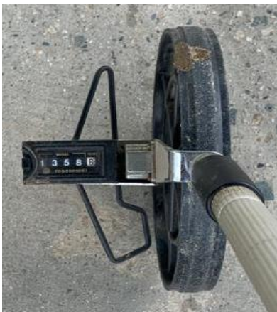
Gambar 3. Pengukuran akhir panjang Jalan Tani Subur dari measure wheel menunjukkan nilai 1.358 meter
