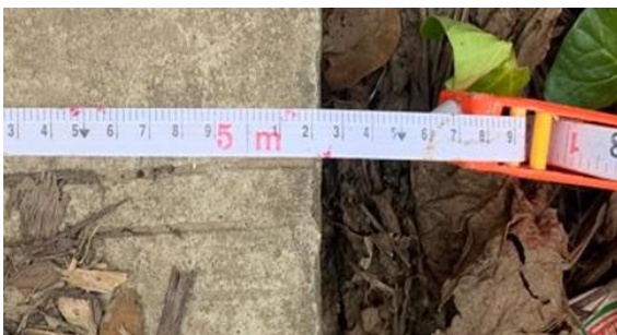
Gambar 4. Pengukuran lebar jalan dari alat ukur Roll meter menunjukkan nilai 5.2 meter
