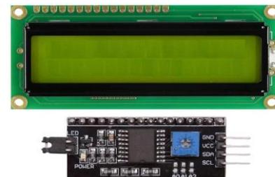
Gambar 4. LCD 16x2 dan I2C [9]
