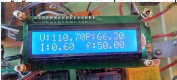
Gambar 10. Hasil pengukuran arus dan tegangan menggunakan PZEM-004T
