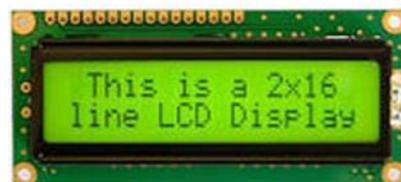
Gambar 6. LCD 16X2 [18].
