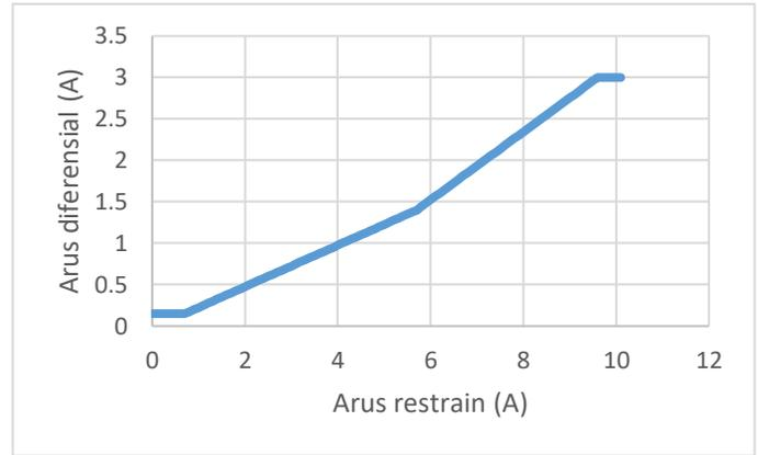
Gambar 9. Karakteristik tripping rele diferensial.
