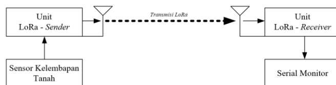
Gambar 5. Diagram blok rangkaian pengujian
