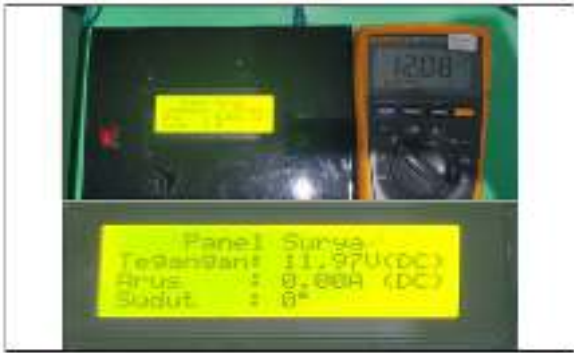
Gambar 23. Hasil pengujian sensor tegangan DC yang dibandingkan dengan alat ukur multimeter Fluke.
