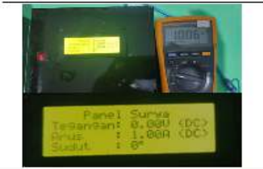
Gambar 24. Hasil pengujian sensor arus WCS1700 yang dibandingkan dengan alat ukur multimeter Fluke.
