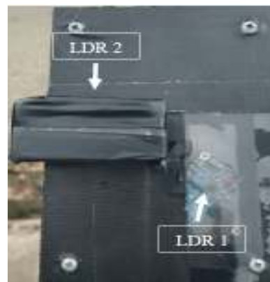
Gambar 27. Bentuk posisi peletakan sensor LDR 1 dan LDR 2.
