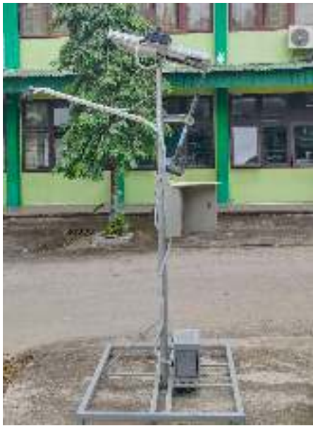
Gambar 29. Miniatur PJUTS dengan sistem solar tracker tampak samping kiri.
