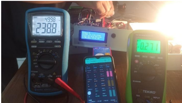
Gambar 19. Pengujian sensor PZEM ID 1 beban lampu pijar 60W
