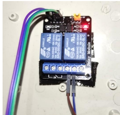
Gambar 21. Pengujian relay on
