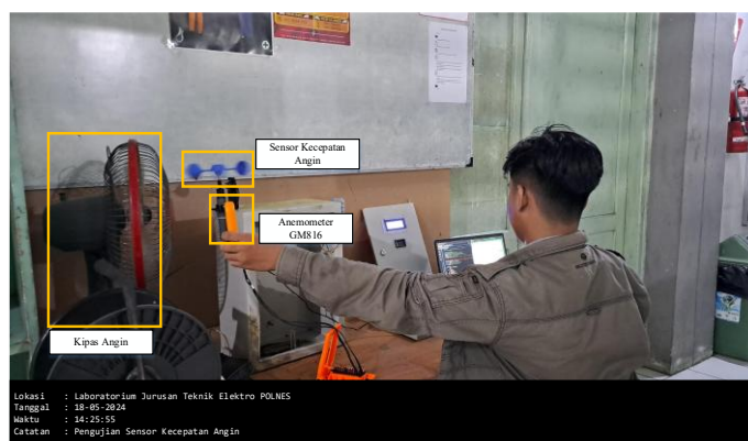
Gambar 18 Pengujian sensor kecepatan angin
