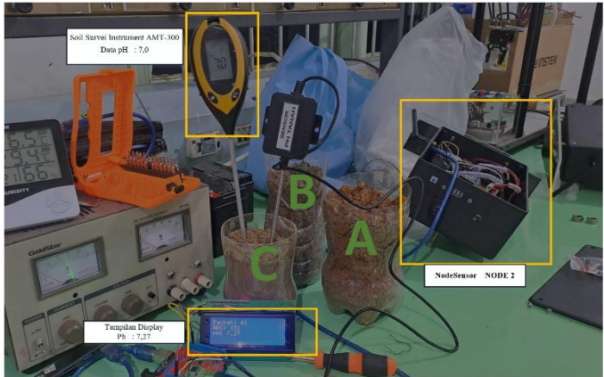
Gambar 20 Pengujian sensor pH tanah
