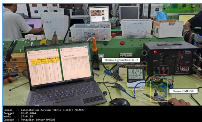
Gambar 17 Pelaksanaan pengujian sensor BME280
