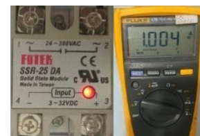
Gambar 10. Pengujian Solid State Relay (SSR) diberikan sinyal HIGH
