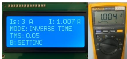
Gambar 9. Hasil pengujian sensor arus PZEM-004Tv30 dengan alat ukur
