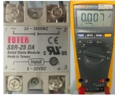
Gambar 11. Pengujian Solid State Relay (SSR) diberikan sinyal LOW
