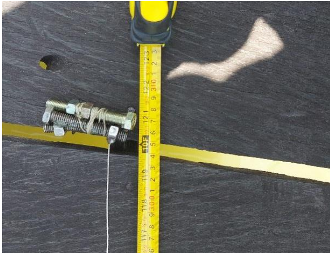
Gambar 26. Pengukuran kedalaman dasar danau dari atas permukaan air
