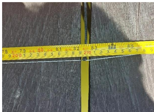
Gambar 25. Pengukuran ketinggian sensor dengan permukaan air
