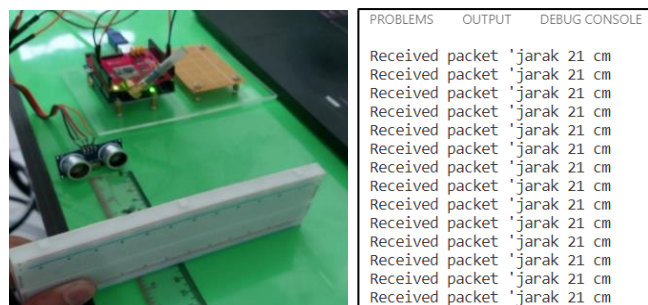
Gambar 19. Pengujian sensor ultrasonik
