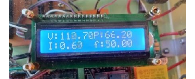
Gambar 10. Hasil pengukuran arus dan tegangan menggunakan PZEM-004T
