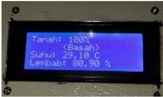
Gambar 15. Hasil pengujian sensor YL-69
