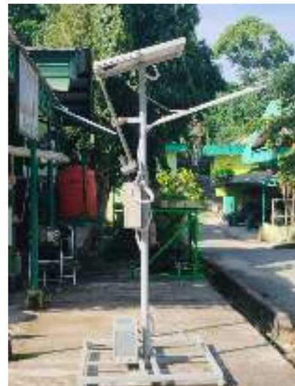
Gambar 28. Miniatur PJUTS dengan sistem *solar tracker* tampak samping kanan.
