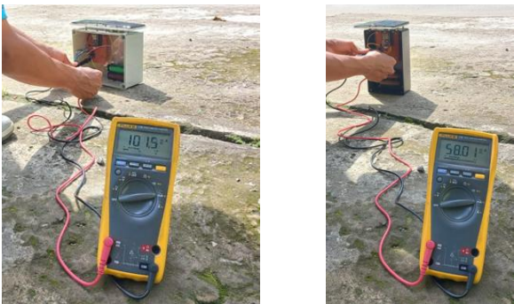
Gambar 16. Hasil pengukuran arus yang dihasilkan oleh sel surya
