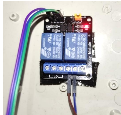
Gambar 21. Pengujian relay on
