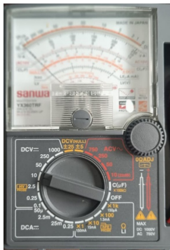
Gambar 6. Jangkah Pengukuran pada posisi Pengukuran tegangan DC
