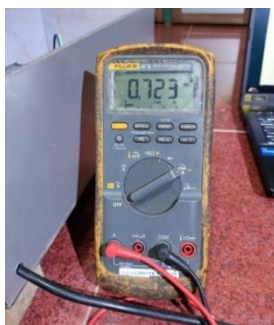
Gambar 28. Arus maksimum motor stepper dengan beban tray semai pada conveyor dan jamur seeder
