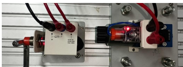
Gambar 24. Visual fisik sensor dan solenoid aktif dalam uji koneksi HMI-PLC
