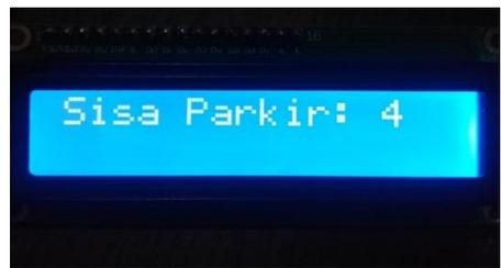
Gambar 36. Tampilan *liquid crystal display* (LCD) saat pengurangan jumlah parkir
