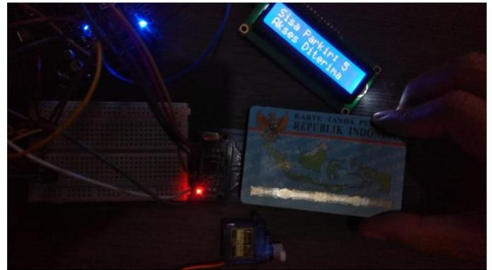
Gambar 25. Tampilan LCD pada *parking gate* ketika UID sudah terdaftar pada Wemos.
