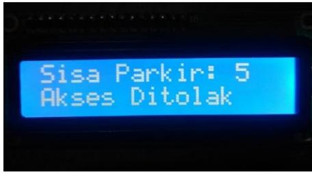
Gambar 34. Tampilan *liquid crystal display* (LCD) Saat UID Belum Terdaftar
