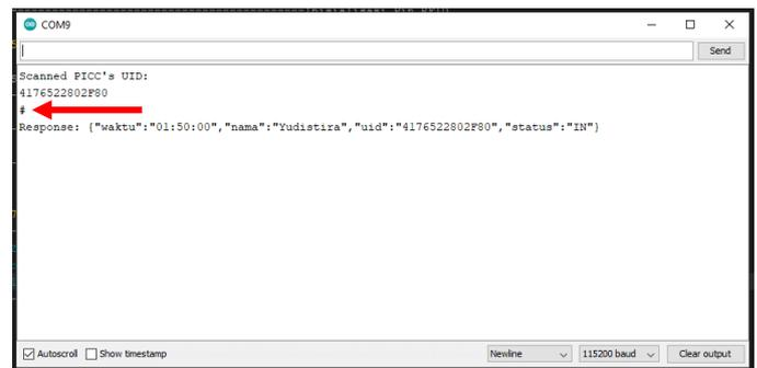
Gambar 31. Pengiriman perintah yang dikirim RFID RC522 dari Wemos Master atau Slave
