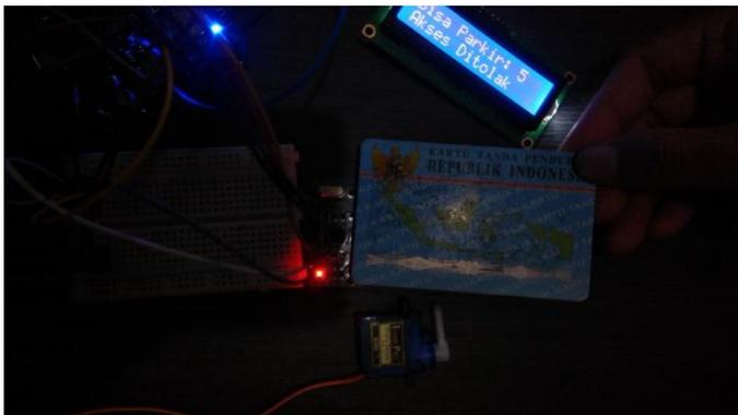
Gambar 23. Tampilan LCD pada *parking gate* ketika UID belum terdaftar pada Wemos.
