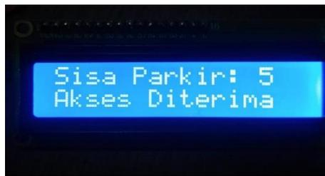
Gambar 35. Tampilan *liquid crystal display* (LCD) saat UID sudah terdaftar
