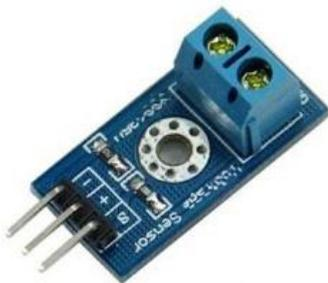
Gambar 11. Modul Sensor Tegangan [7].
