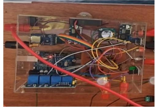
Gambar 13. Alat Monitoring Arus dan Tegangan Berbasis Arduino
