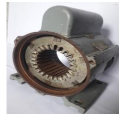
Gambar 2. Stator mesin listrik type JY2B - 2.
