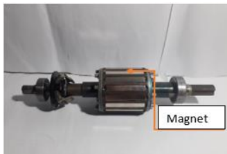
Gambar 6. Pemasangan magnet pada rotor
