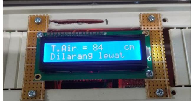
Gambar 21. Tampilan pada DN ketika data ketinggian air yang diterima adalah 84 cm
