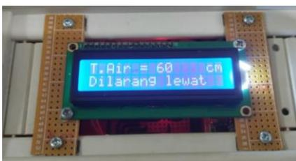
Gambar 30. Tampilan pesan pada DN untuk data tinggi air dari SN1= 50 cm dan SN2= 70 cm
