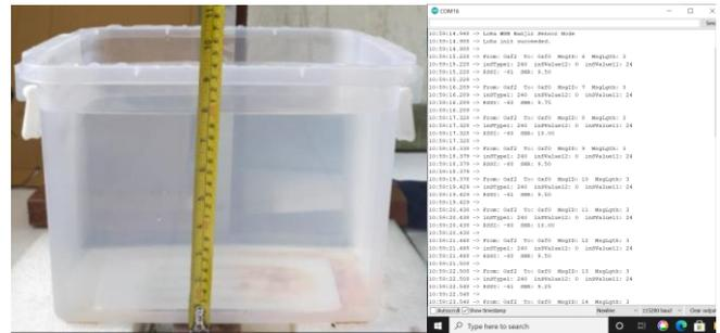
Gambar 17. Pengujian pada *box* plastik kecil dengan tinggi 24 cm
