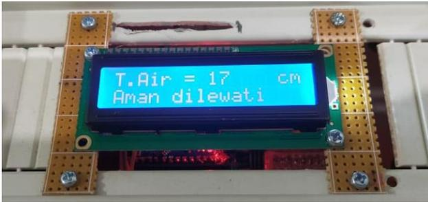
Gambar 19. Tampilan pada DN ketika data ketinggian air yang diterima adalah 17 cm
