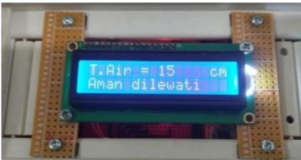
Gambar 24. Tampilan pesan pada DN untuk data tinggi air dari SN1= 10 cm dan SN2= 20 cm
