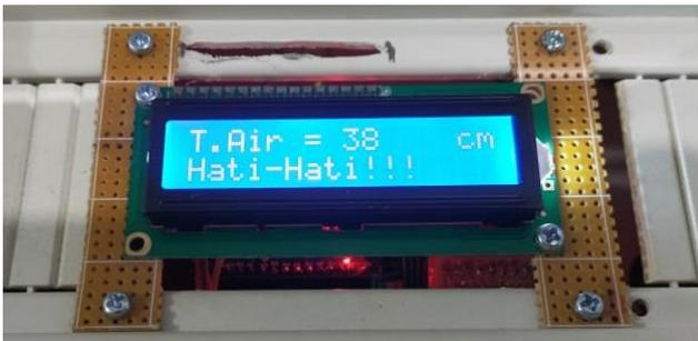
Gambar 20. Tampilan pada DN ketika data ketinggian air yang diterima adalah 38 cm
