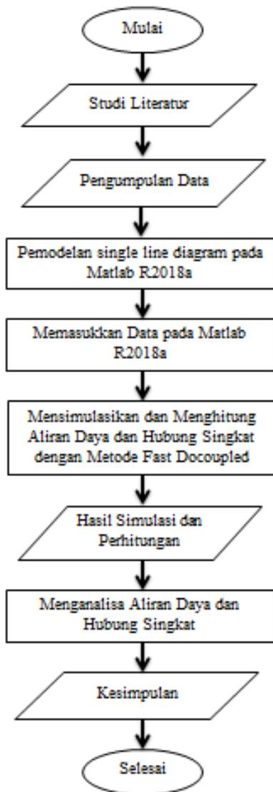
Gambar 4. Flowchart alur analisa aliran daya dan hubung singkat
